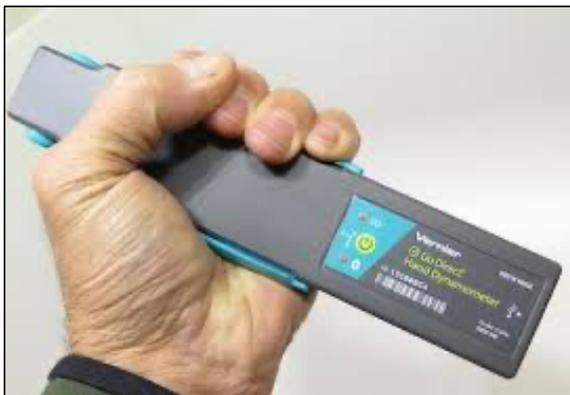
Figure 2. Hand Dynamometer
